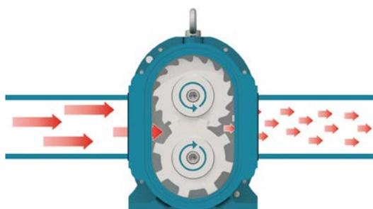
*Feststoffe, die in Flüssigkeiten enthalten sind, zerkleinert der Doppelwellen-Zerkleinerer Unihacker effektiv und zuverlässig und sorgt so für den reibungslosen Betrieb nachgeschalteter Maschinen und Pumpen.*
