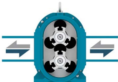
*Börger Drehkolbenpumpen werden seit mehr als 35 Jahren in der Kommunal- und Umwelttechnik eingesetzt. Die feststoffunempfindlichen Pumpen sind leistungsstark, zuverlässig und arbeiten effizient. Börger Pumpen fördern problemlos verschmutzte, schlammige und abrasive Medien.*
