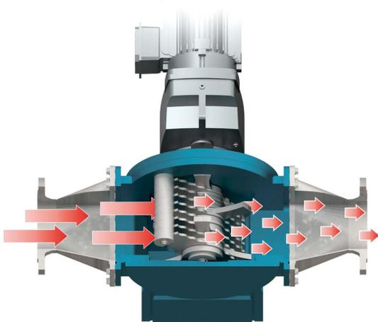
*Der Rotorrechen ist überall dort stark, wo andere Zerkleinerer Probleme haben – bei der Zerkleinerung von sehr groben Feststoffen und „Verzopfungen“. Im integrierten Fremdstoffabscheider werden nicht zu zerkleinernde Teile aufgefangen.*
