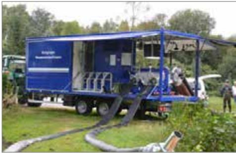
*Notre pompe à lobes haute performance possède un débit maximal de près de 24.000 l/min. Elle est entraînée par un moteur diesel et est installée sur une remorque poids lourd.*
