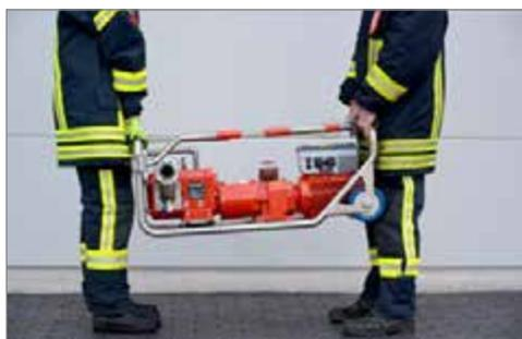
*Börger a développé une pompe mobile portable destinée à intervenir dans les zones difficiles d'accès. Cette pompe résistante aux particules étrangères est équipée d'une motorisation avec variateur de fréquence intégré.*
