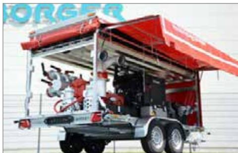
*Entraînées par une motorisation thermique, nos pompes à lobes mobiles Börger sont totalement autonomes. Le débit maximum de 15.000 l/min peut être atteint par un groupe installé sur une remorque tractable par une automobile.*
