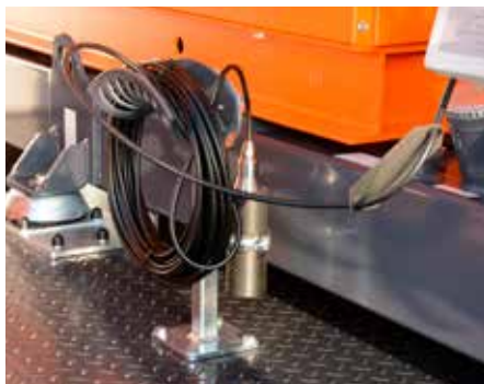
automatische bediening/werking via niveausensor
