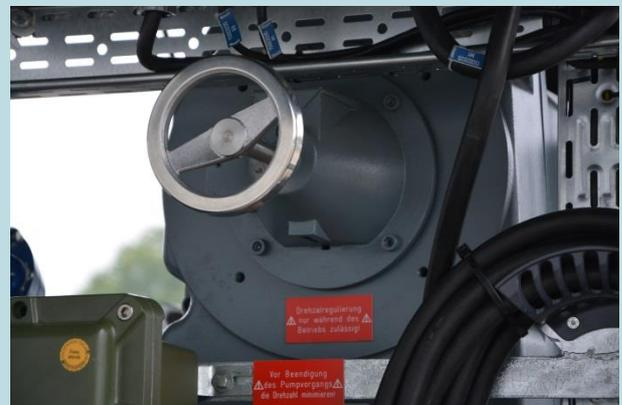
Verstellgetriebemotor, 22 kW,
