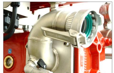
Tankwagenkupplung (TW) DN 50 an Saug- und Druckseite
