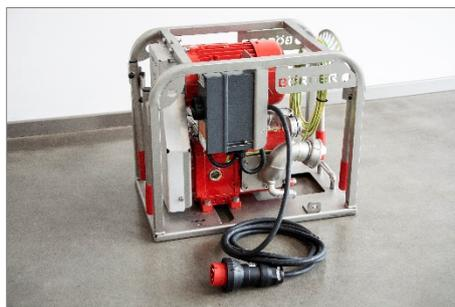
Stromzufuhr über einen explosionsgeschützten Stecker
