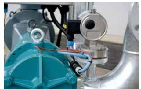
Trockenlaufschutz durch Temperaturmessung im Förderraum
