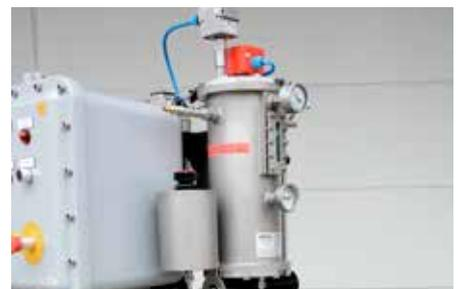
TS-Behälter mit Füllstandüberwachung, Druckabsicherung, Umwälzpumpe und Temperaturüberwachung des Sperrmediums
