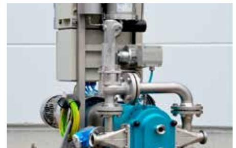
Überdruckschutz durch Bypass mit Sicherheitsventil
