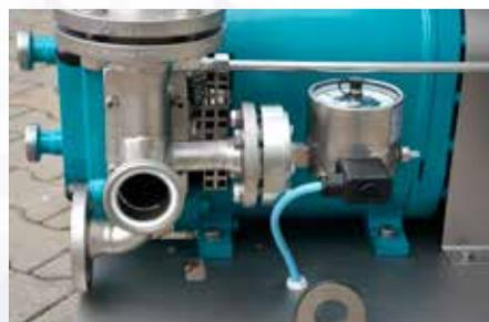
elektronische Druckmessung an Saug- und Druckseite
