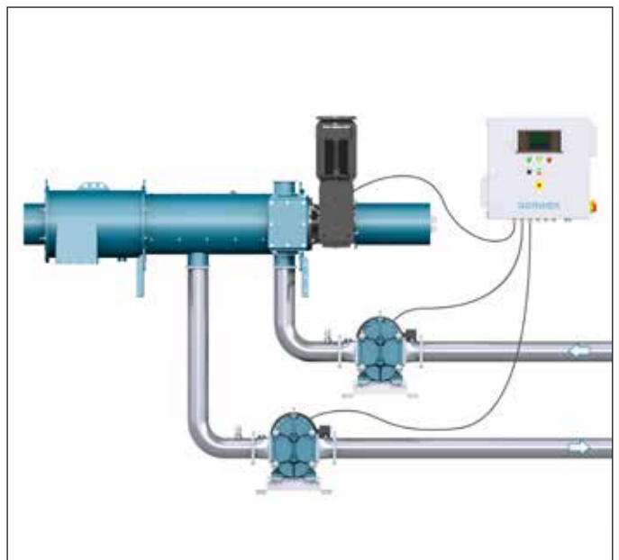
Alternativ kann eine gesteuerte Filtratpumpe die flüssige Phase zur weiteren Verwendung fördern. Ein Zwischenbehälter wird nicht benötigt.
