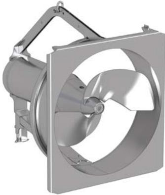
Das B-MX ist auch für Zirkulationskanäle (Flüssigmistkanäle im Slalomsystem) geeignet. Das Tauchmotorrührgerät saugt die Flüssigkeit über die Motorseite und drückt sie durch den Rühr-tunnel, so dass ein Bewegungsstrom entsteht.
