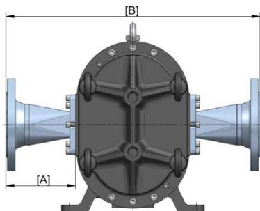
**Bauform 1 | Anschlussstutzen mit Anschlussflansch und O-Ring Dichtung in mm**
