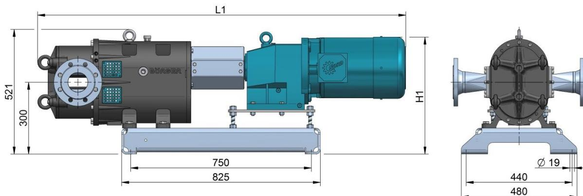
**Standard-Aggregat-Ausführung in mm**
