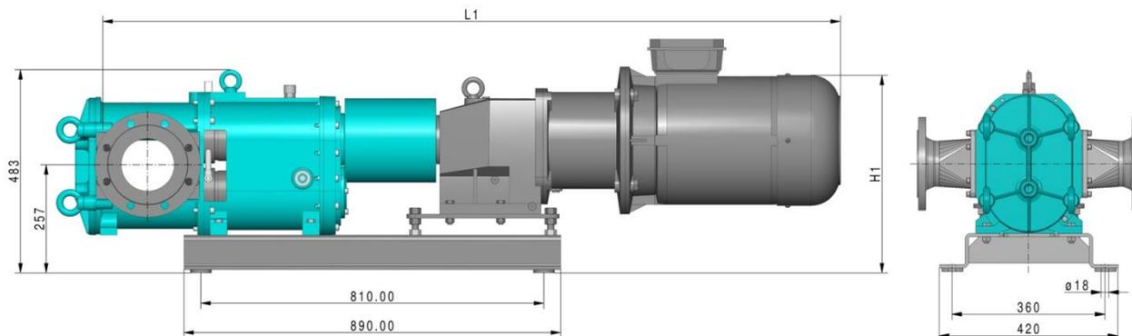
**Standard-Aggregat-Ausführung in mm**
