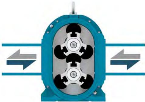
Les pompes à lobes sont installées depuis plus de 35 ans dans les stations de traitement des eaux usées communales ou industrielles avec succès. Les pompes à lobes Börger sont auto-amorçantes à sec, sans clapet ni soupape, réversibles et quasiment insensible à la marche à sec. Elles assurent le pompage de tous types d'eaux usées, boues, graisses avec présence de filasses de façon fiable.
