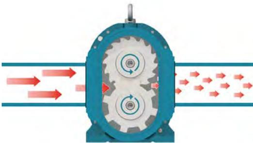
*Le Unihacker est un broyeur à double arbre parallèles et à couteaux multiples. Il peut être installé à l'aspiration de pompes ou encore en protection de centrifugeuses par exemple.*
