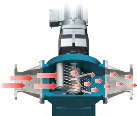
*Le rotocrusher est un robuste dilacérateur s'intégrant en ligne sur la tuyauterie. Les couteaux rotatifs et les contre-couteaux sont disposés en alternance et séparés par des entretoises. Le rotocrusher intègre également un piège à cailloux intégré afin de séparer les indésirables.*
